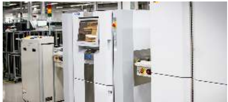
3D AOI Anlage mit anschließender Röntgeninspektion
